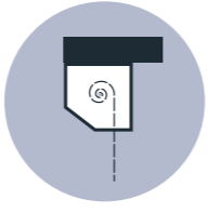
sous linteau inversé
